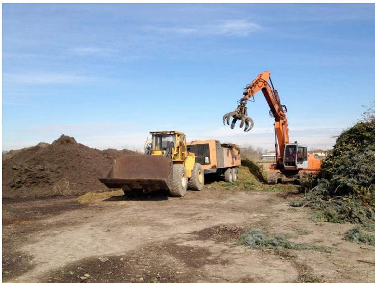
*esempio carico del biotrituratore con escavatore dotato di ragno*
