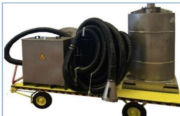
Figura 17 – Sistemi di aspirazione carrellati
