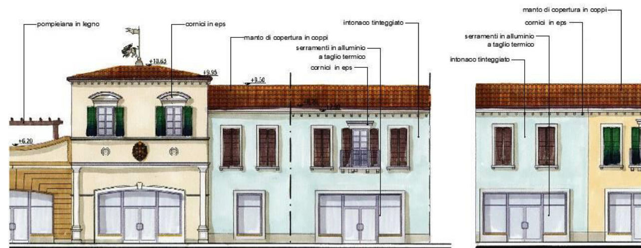
Particolare prospetti ampliamento fase 1 e 2
