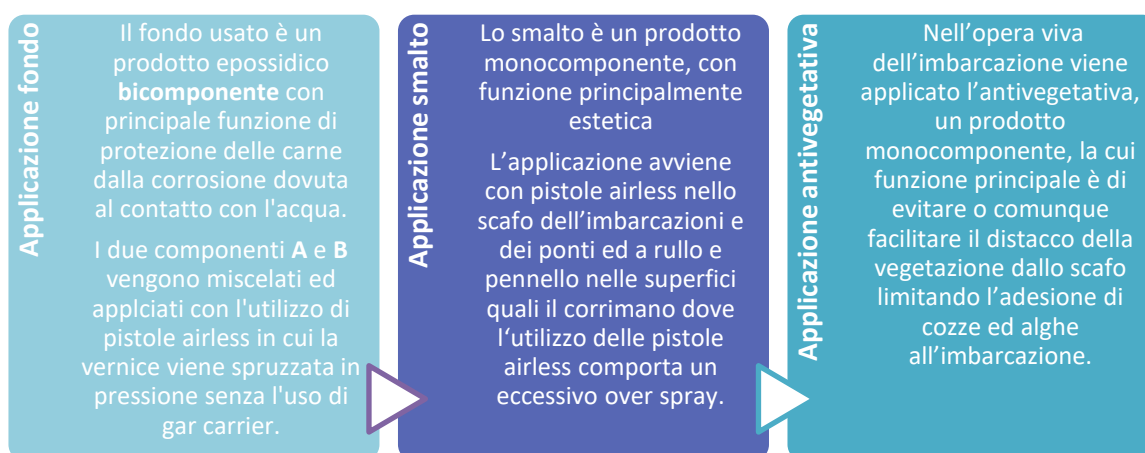
Figura 2: Schema riassuntivo dell'applicazione delle vernici
