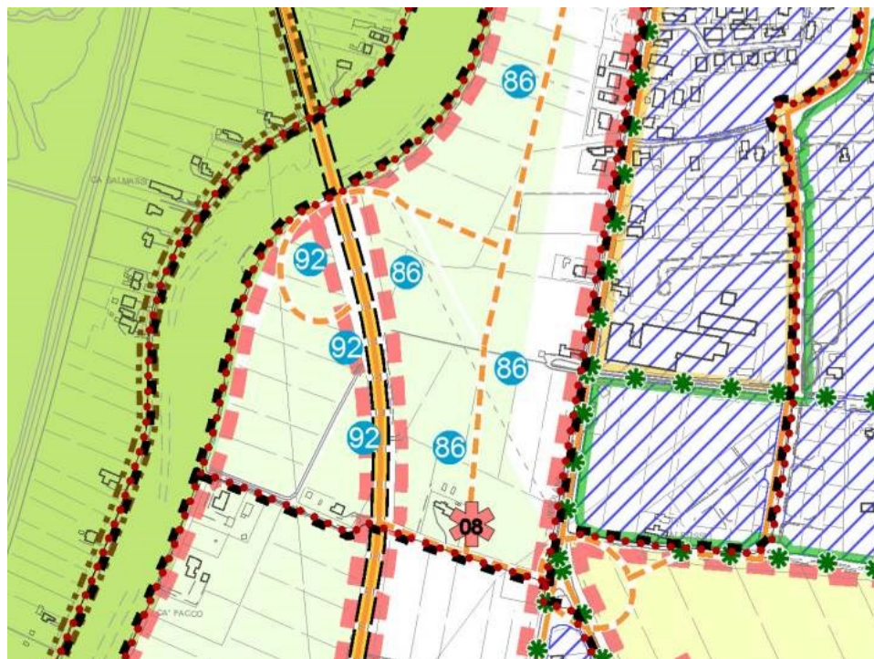
Ingrandimento dell'estratto PAT – Tav. T04 del settore interessato dalla realizzazione della bretella fra SR 43 e SP 42, dove si vede il tracciato schematico della stessa e della rotatoria con via Mameli indicati con linee tratteggiate di colore rosa-arancio e spessore differenziato in relazione alla gerarchia territoriale dell'infrastruttura (Fonte: comune di Jesolo).
