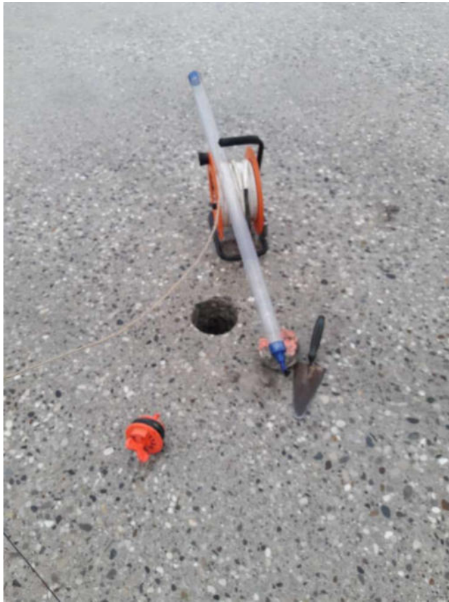
campionamento acqua da piezometro S1 (sondaggio deposito sabbia)
