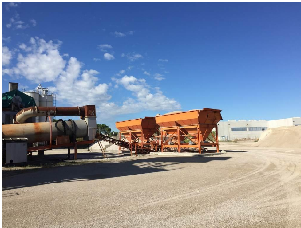
Foto 5 – Area caricamento inerti e forno per essiccazione e miscelazione
