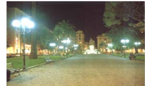
Impianto che disperde oltre il 60% della luce verso l'alto. I corpi illuminanti a sfera sono gli strumenti d'illuminazione più inquinanti ed inefficienti
