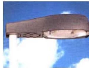
ARMATURA STRADALE ACCETTABILE (Diffusore curvo ma corpo orizzontale) Solo se emissione oltre 90° è minore del 3 % del flusso totale emesso
