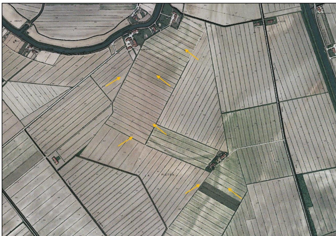
FIGURA 5 – LE FRECCE INDICANO LA TRACCIA DI UN PALEOALVEO EVIDENZIATA DA UNA TRACCIA SINUOSA A FIRMA SPETTRALE SCURA, CORRISPONDENTE ALLA LINEA DELL'ALVEO FLUVIALE, AFFIANCATA DA DUE FASCE A FIRMA SPETTRALE CHIARA IN CORRISPONDENZA DEGLI ARGINI NATURALI.
