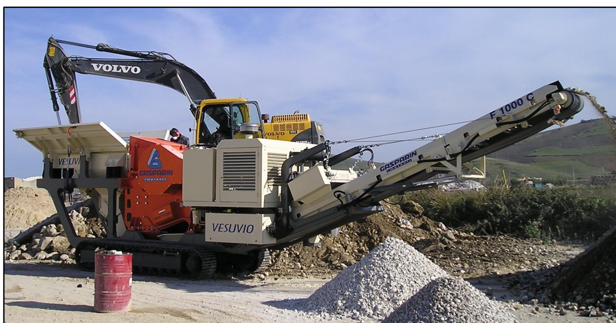
Figura 10: Frantumatore GASPARIN IMPIANTI SRL modello "Vesuvio" (foto fornita dalla casa costruttrice Gasparin-Omg Srl)
