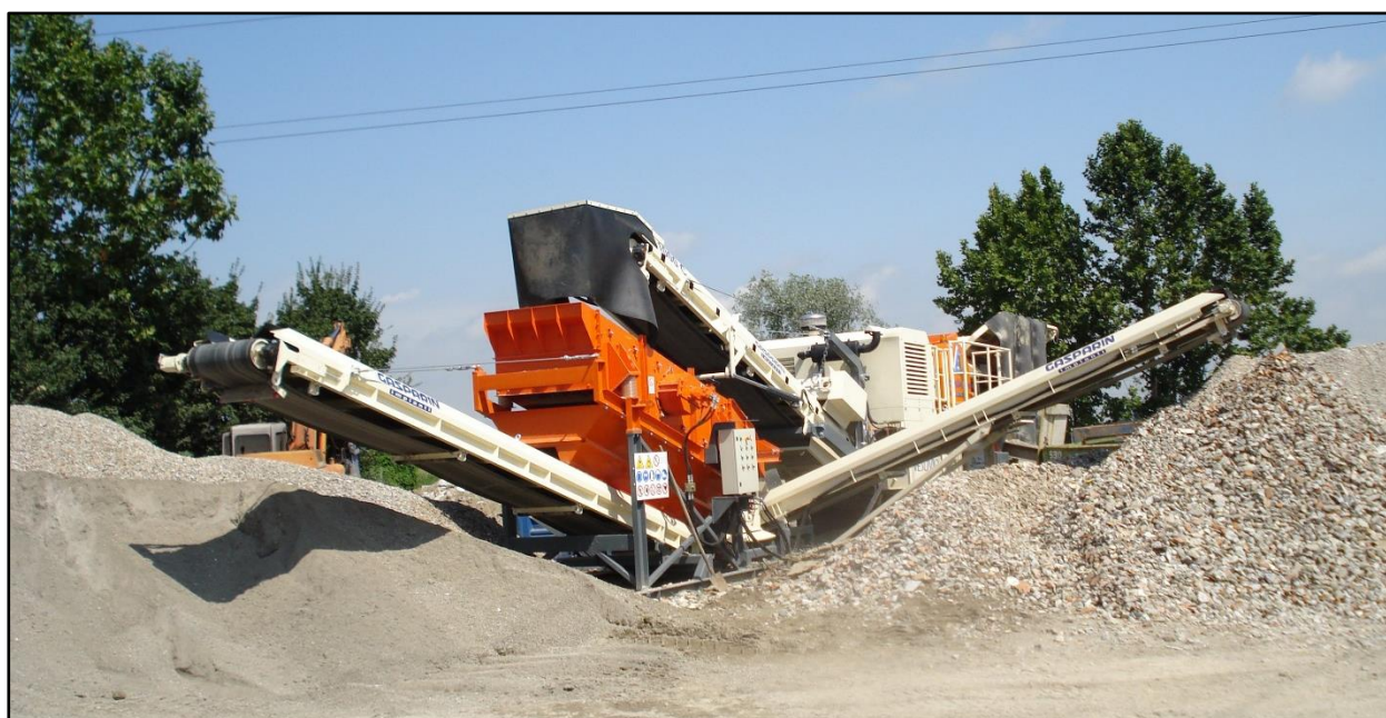
Figura 12: Vaglio GASPARIN IMPIANTI SRL modello GV 1230 (foto fornita dalla casa costruttrice Gasparin-Omg Srl)
