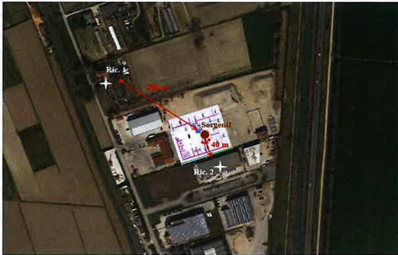
La scelta sui punti di misura è stata condotta per cercare di coprire il più possibile tutti i ricettori vicini. La scelta sulla durata della misura, pari a 3 ore, è stata condotta per poter misurare il rumore di fondo anche con l'impianto acceso (prima ora) e confrontarlo con l'impianto spento (seconda ora), è stata poi condotta un'altra misura durante la pausa dell'attività (terza ora).
