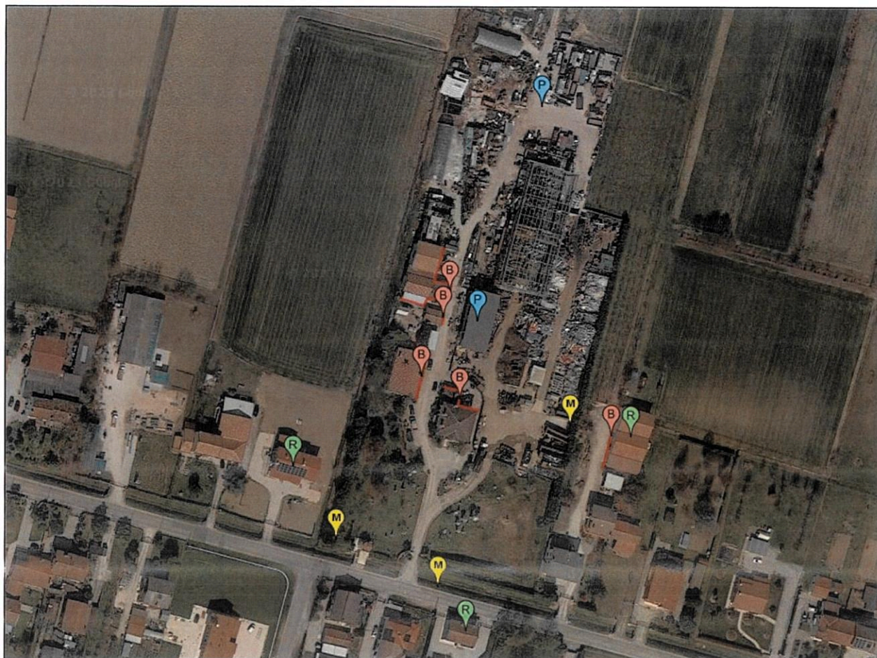
In figura, l'indicazione delle sorgenti (in blu), dei recettori (in verde), delle misure ai recettori (in giallo) e delle barriere (in rosso) presenti considerate per i calcoli fonometrici.
