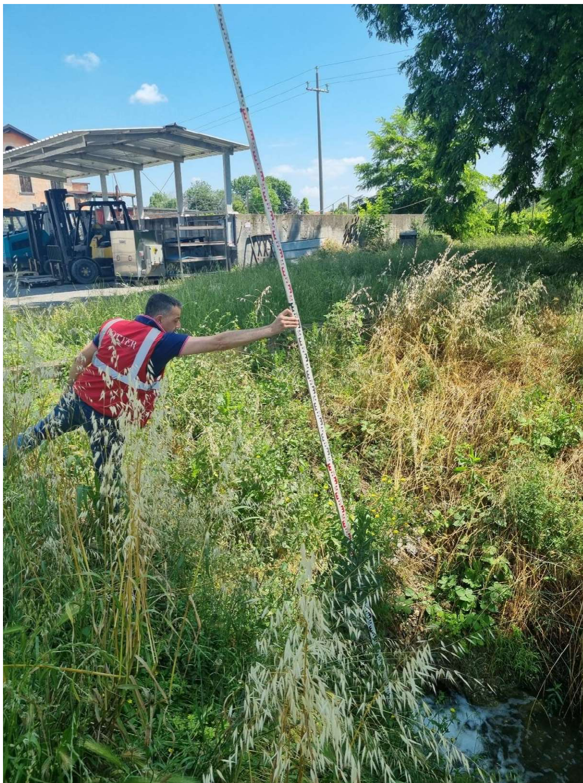
Foto 3: misurazione della profondità del rio Palombetto: 2,5 m dal piazzale asfaltato, il battente d'acqua è di circa 30 cm
