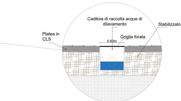
**Dettaglio Pacchetto Impermeabilizzato**
