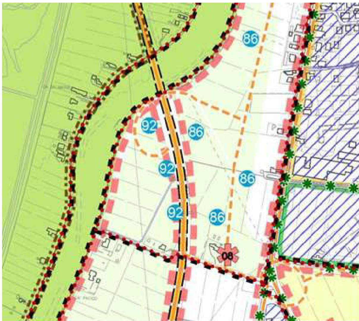
Ingrandimento dell'estratto PAT – Tav. T04 del settore interessato dalla realizzazione della bretella fra SR 43 e SP 42, dove si vede il tracciato schematico della stessa e della rotatoria con via Mameli indicati con linee tratteggiate di colore rosa-arancio e spessore differenziato in relazione alla gerarchia territoriale dell'infrastruttura (Fonte: comune di Jesolo).
