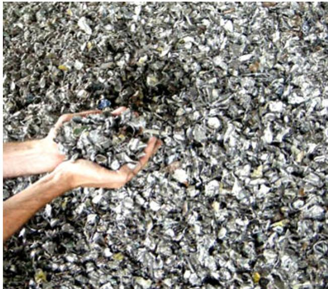
Figura 2 – esempio di proler di ferro
