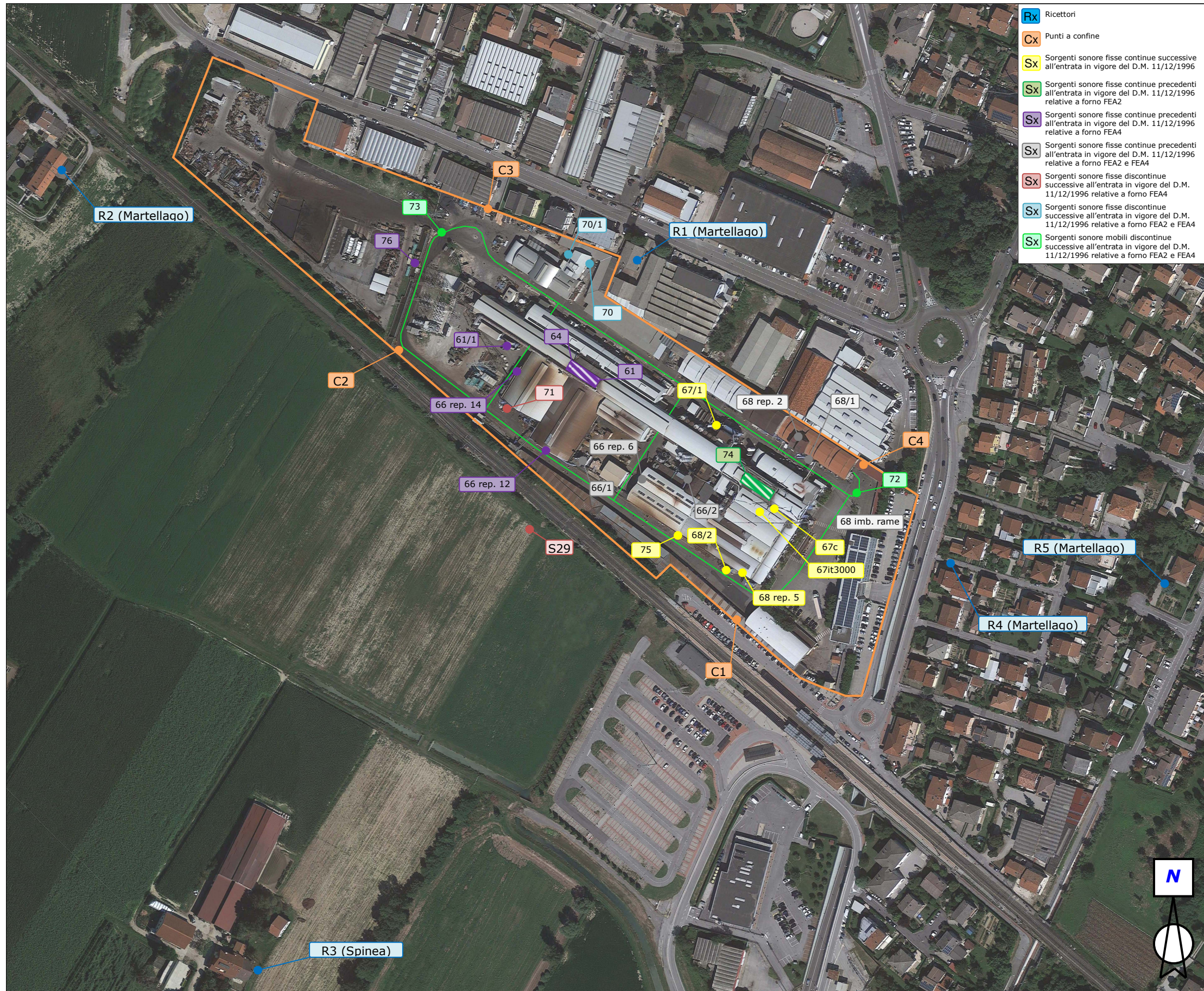
Figura 13.1. Localizzazione misure a confine e presso ricettori e ubicazione sorgenti sonore dell'impianto
