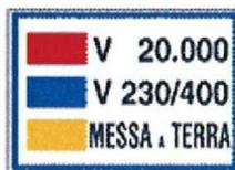
Cartello di identificazione dei circuiti con diverse colorazioni per i diversi livelli di tensione e per i conduttori di messa a terra
