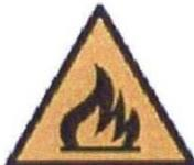
Cartello di avvertimento di pericolo che può essere integrato, ad esempio, con la scritta: pericolo di esplosione per la presenza di batterie di accumulatori
