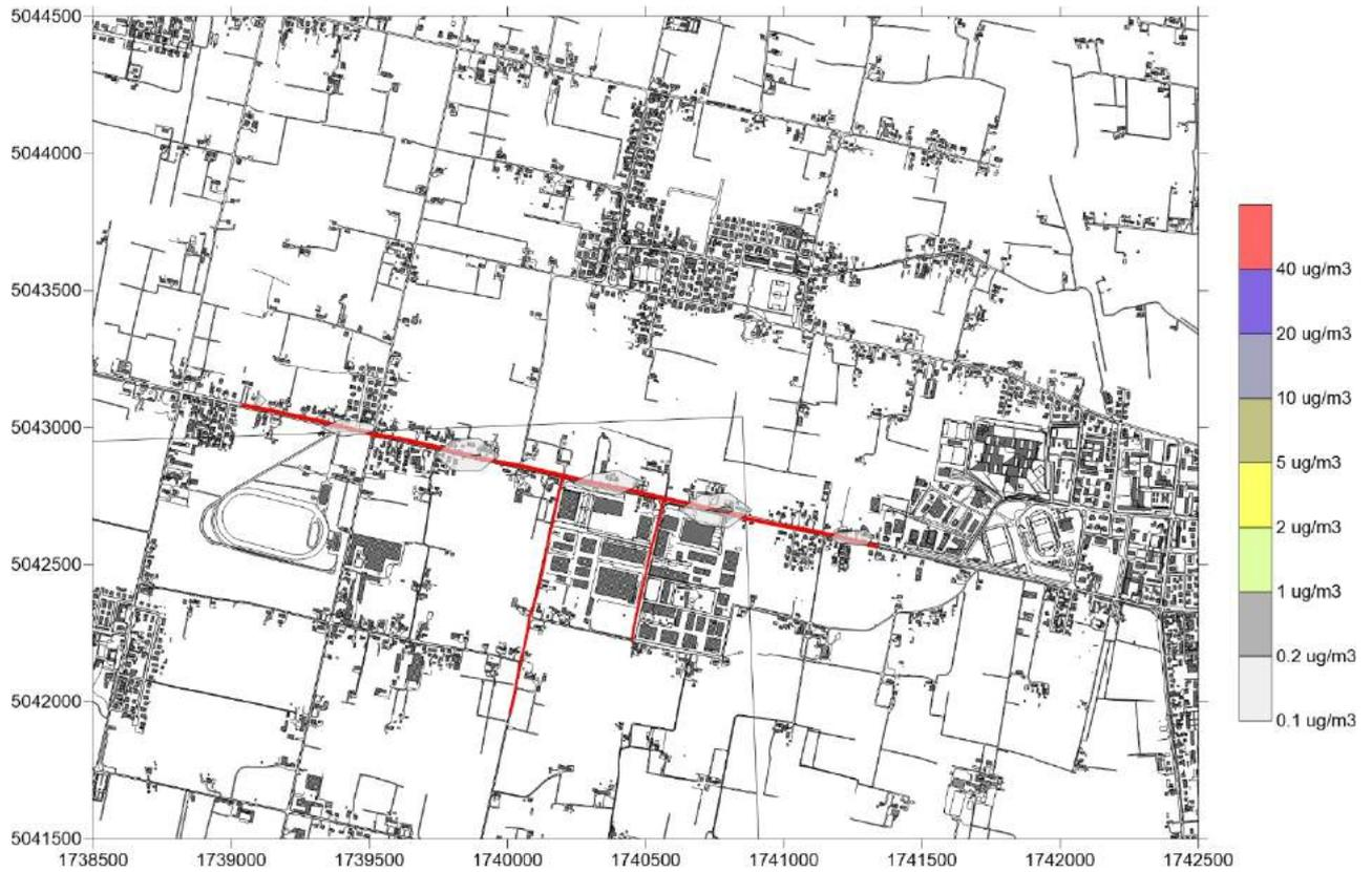
3. Applicazione del modello di dispersione. Scenario traffico indotto dall'ampliamento della struttura commerciale inquinante PM10, 35° massimo annuo della media giornaliera (limite di legge 50  $\mu\text{g}/\text{m}^3$ )
