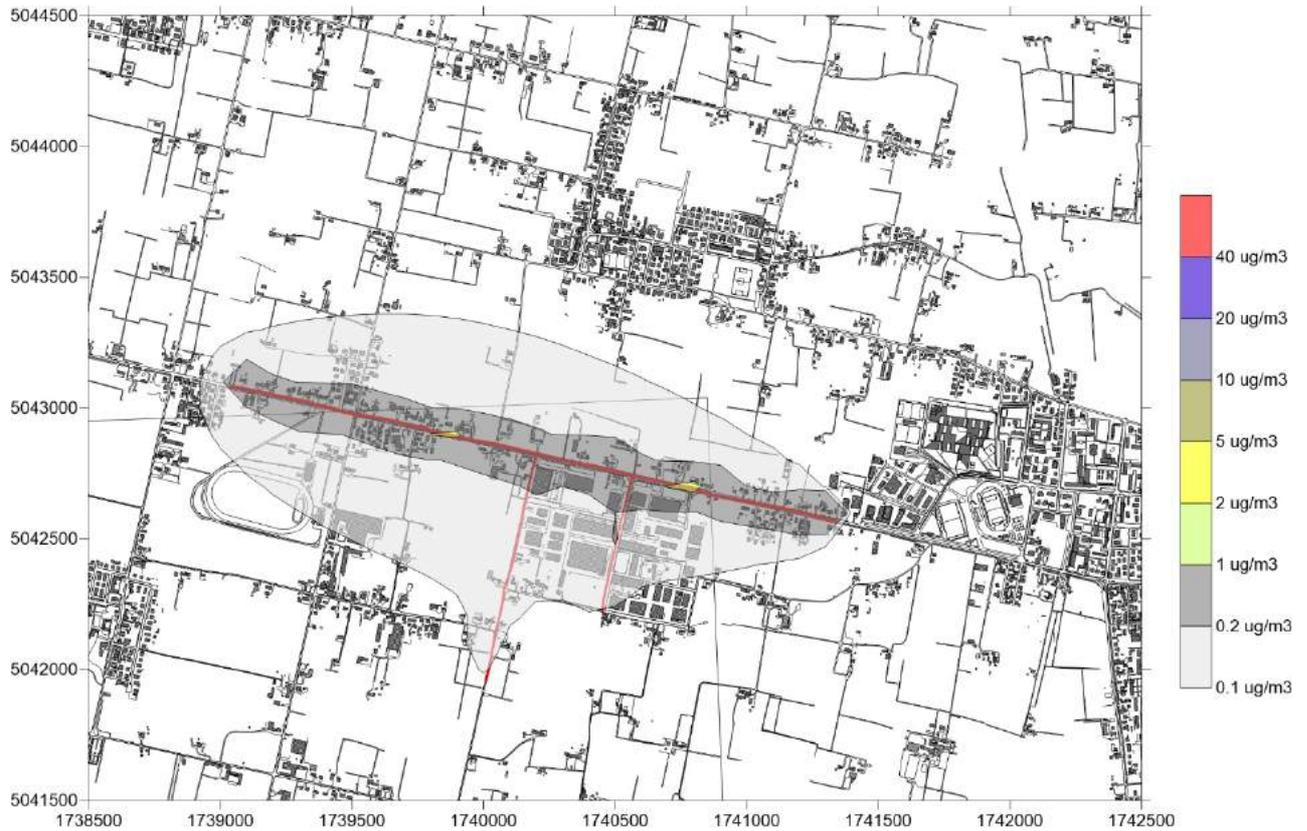
5. Applicazione del modello di dispersione. Scenario traffico indotto dall'ampliamento della struttura commerciale inquinante  $\text{NO}_2$ , 18 concentrazione massima annua della media oraria (limite di legge  $200 \text{ NO}_2 \text{ g/m}^3$ ).
