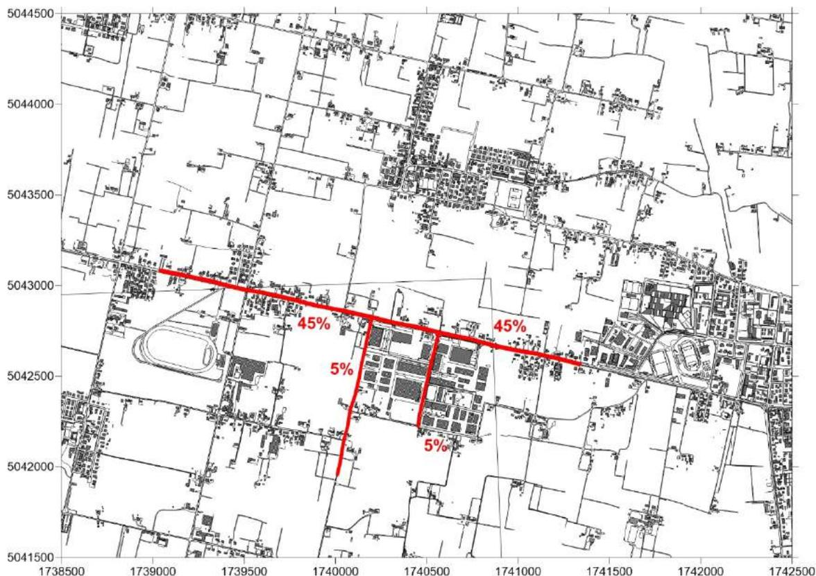
**Figura 4** Distribuzione dei volumi di traffico indotto dall'ampliamento della struttura commerciale
