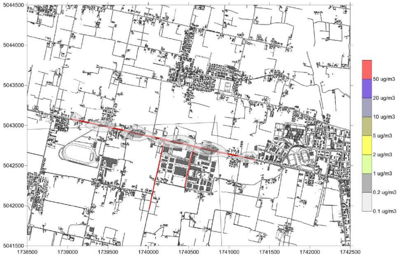
4. Applicazione del modello di dispersione. Scenario traffico indotto dall'ampliamento della struttura commerciale inquinante  $\text{NO}_2$ , media aritmetica annua (limite di legge  $40 \text{ g/m}^3$ ).
