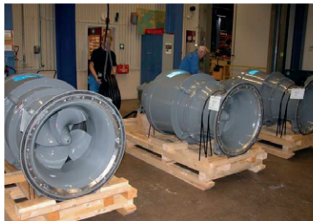
Fig. 4.22 - Le moderne pompe a elica.
