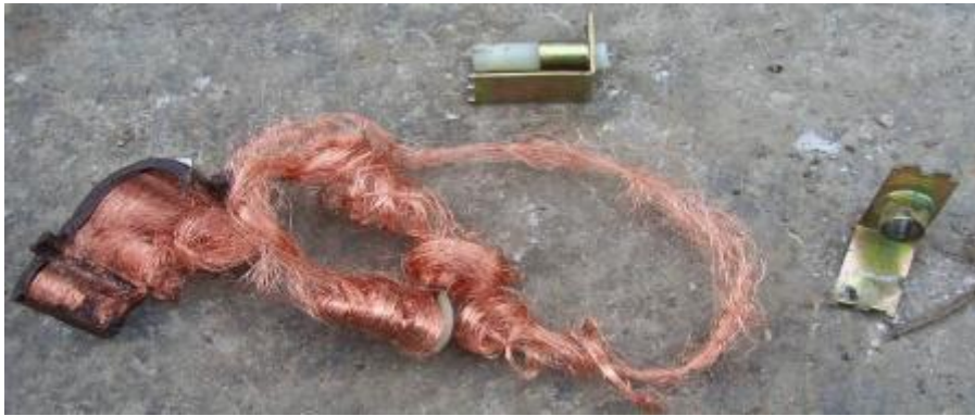
Figura 14 – Immagini fasi di smontaggio trasformatore
