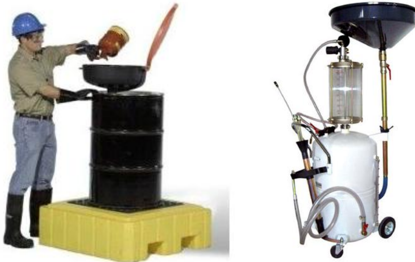
Figura 35 – Immagini esemplificative di contenitori e sistemi di estrazione che saranno acquistati dalla Maniero.
