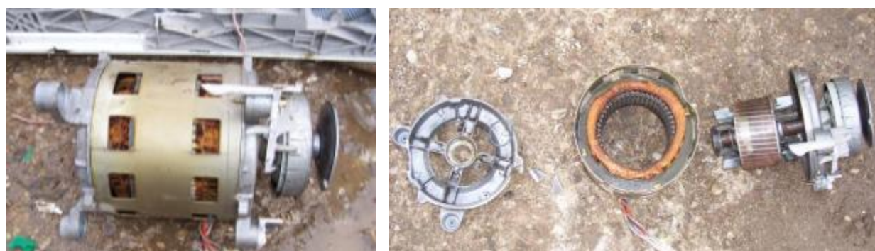
Figura 13 – Immagini fasi di smontaggio motore elettrico
