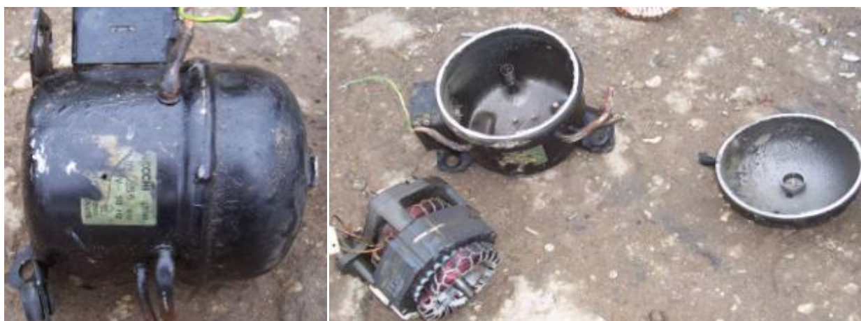
Figura 12 – Immagini fasi di smontaggio compressore
